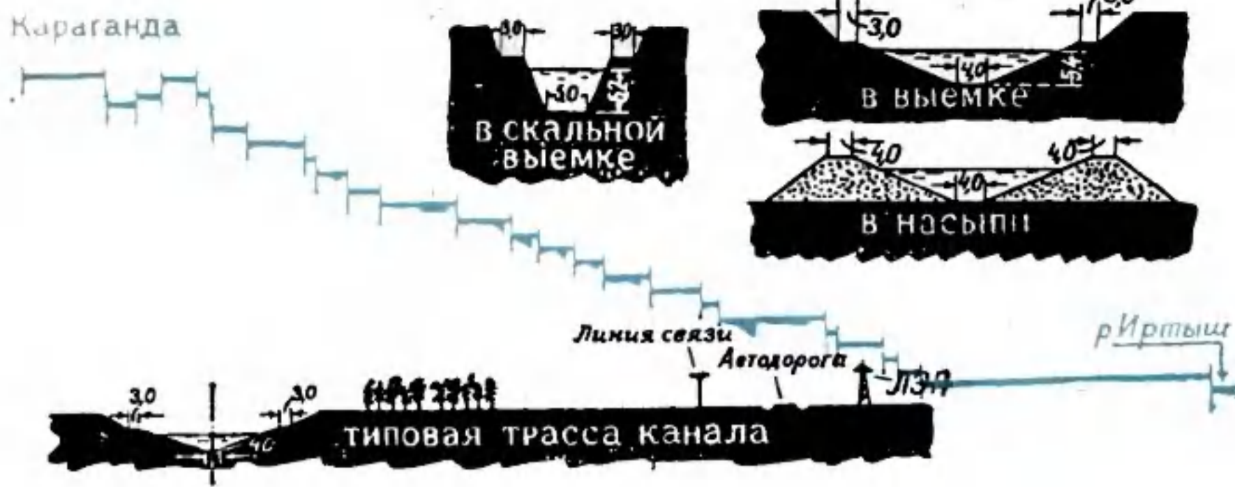
Гидротехнический профиль канала.
