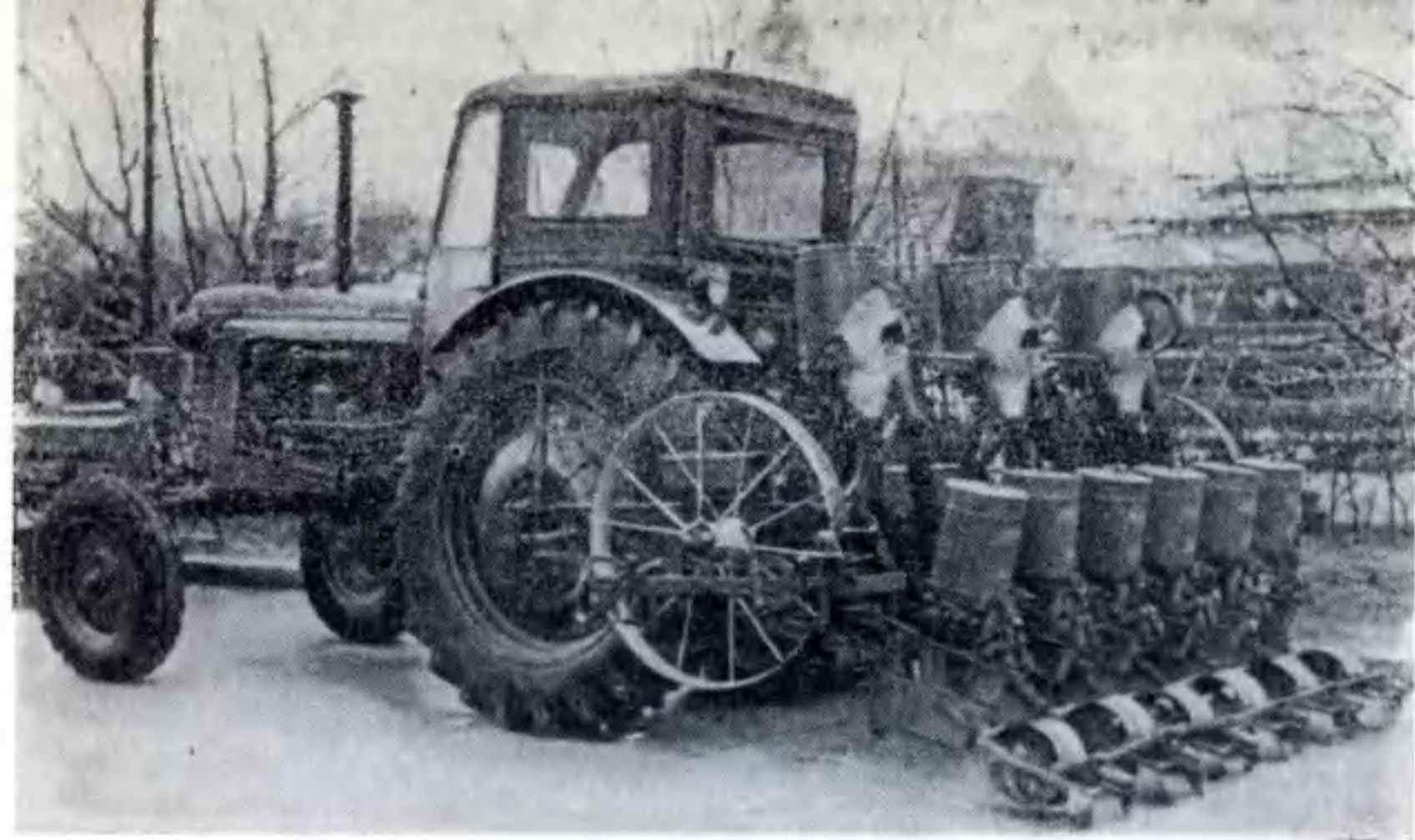
Квадратно-гнездовая сеялка «СКГС-6» для посева сахарной свеклы.
